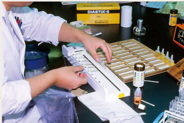
1件ずつ試験紙に尿を掛け、その色の変化を確認する
